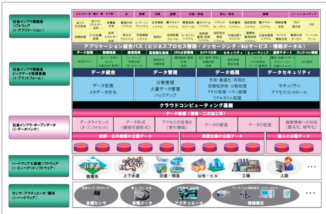
図3-1 IoT向け情報処理基盤の階層モデルと機能
