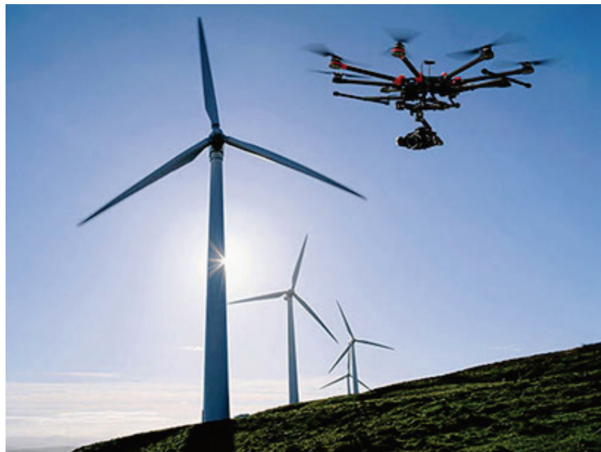
資料 1.4.5 風力タービンプレードのドローン検査に AI を活用する Clobotics
