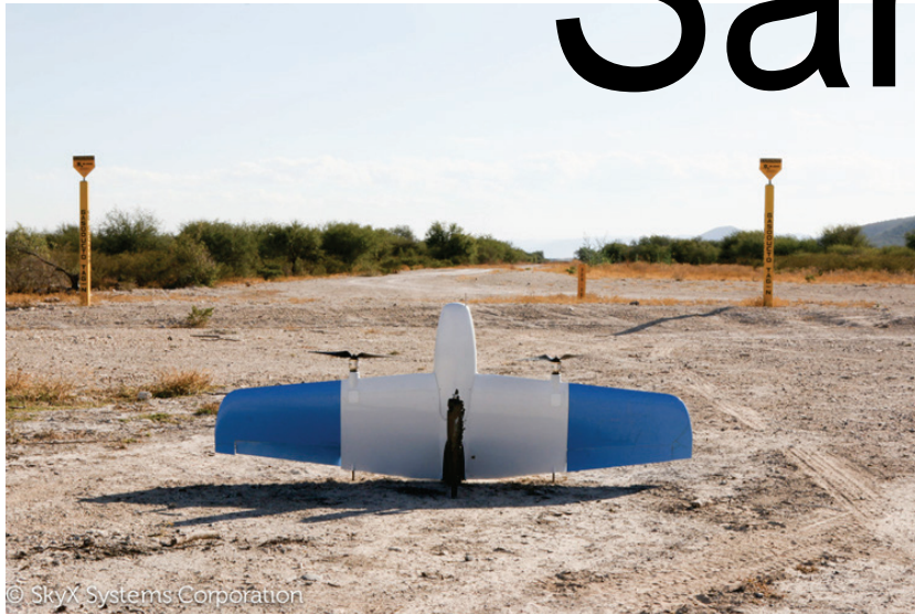
資料 2.1.3 4つのプロペラを備えた VTOL 型ドローンの SkyOne
