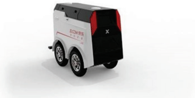
資料 1.6.30 NVIDIA社のJetsonを搭載するJD XのJDrover
